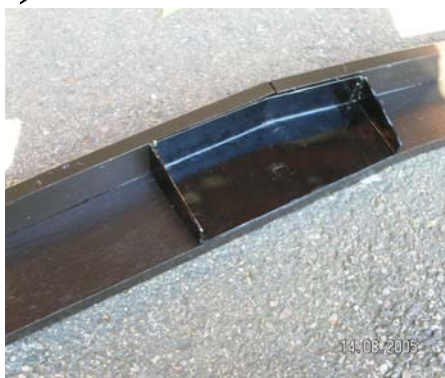
Förstärkning under cille vid B-stolpe.
