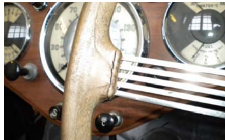
Cellulosaacetat-plast-ratt i gold pearl finish komplett med sprickbildning där rattekrarna går in i rattningen.
