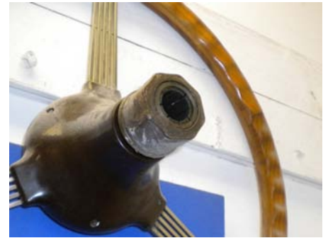
Ratt typ 4 med spännhylsa. Just denna ratt har fått en ratt-ring i amerikansk valnöt. Se Rileybladet 3/2004 sidan 6.
