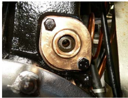
Kamaxelbussning (insug, bakre) med fästskruvar. Pluggen har skruvats ur.
