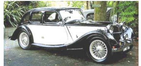
Kestrelkarossen med sluttande bakparti tillverkades med två eller tre sidorutor och fanns på Nine-, 12/4-, 14/6-, 15/6- och Big Four-chassierna. Detta är en 12/4 från 1936
