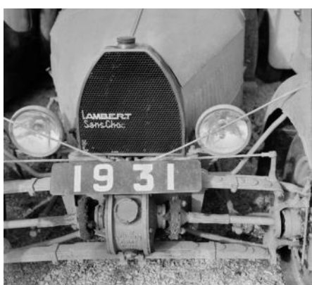
Lambert truck Sans Choc med separat fjädring på samtliga hjul
