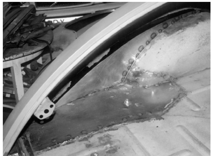
Ny plåt insvetsad. Vänster bakre hjulhus och bagagerumsdurk.
