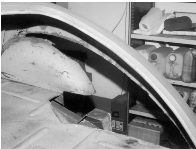
Här har vinkelslipen gått fram hårt. Höger bakre hjulhus och bagagerumsdurk.
