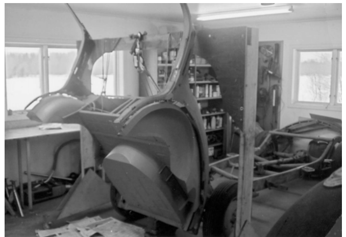
Även undersidan bör prepareras. Här med Hagmans CA epoxy-grundfärg.
