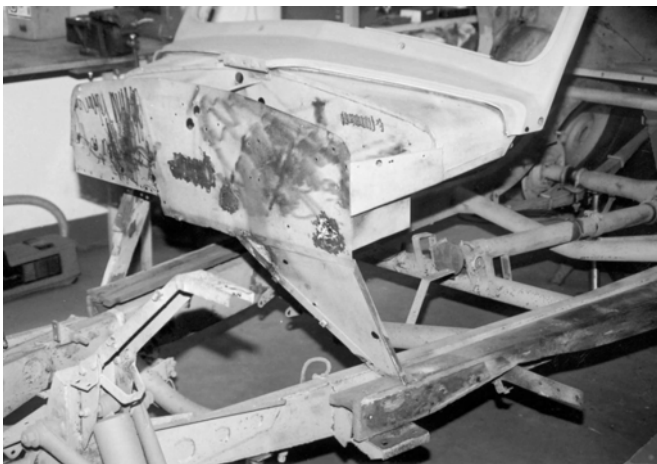
Paneler och fäste för A-stolpe avlägsnad för svetsoperation.
