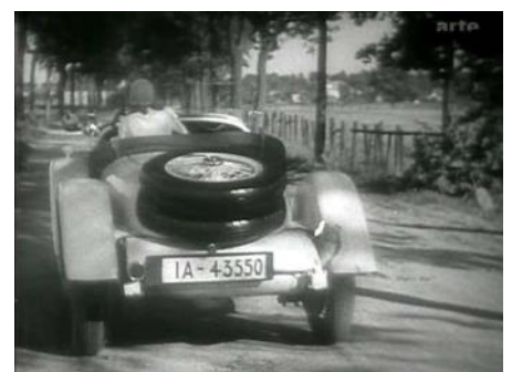
Bilen i filmen var en 1929 års Mercedes-Benz W 08 18/80 PS Typ Nürburg 460 K Sport-Roadster. Den hade en rak åtta på 4622 cc som gav en topphastighet på 100 km/tim.
