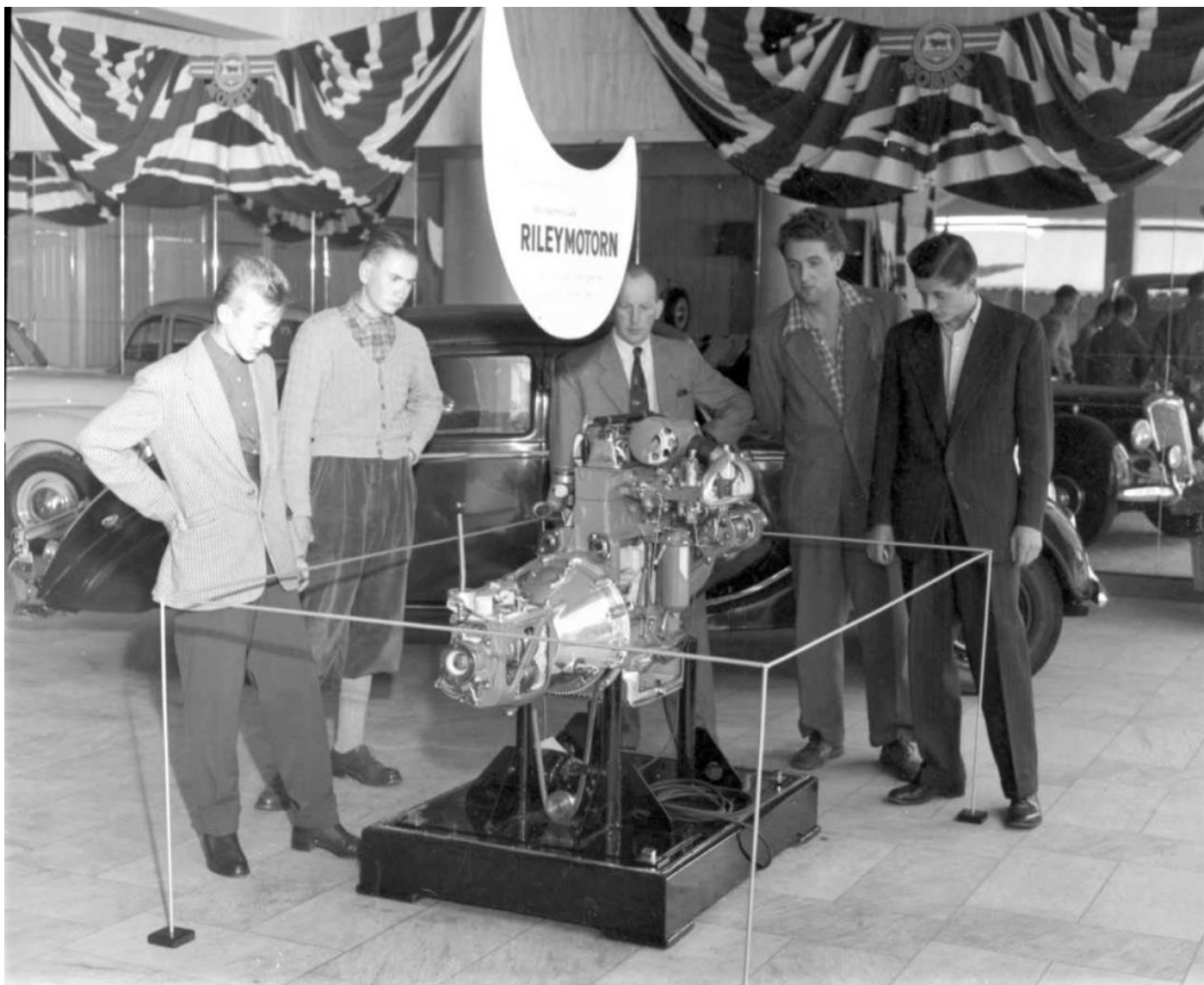
Detta foto är taget i samband med Förenade Bils brittiska bilmässa 1955. Här visas funktionen hos en Rileymotor. Den har sannolikt lånats in från BMC i England. Motorn är uppskuren i demonstrationssyfte och vrids runt av en elmotor. Bakom åskådarna står en 2½ liters Riley. Sådana slutade tillverkas två år tidigare. Märkligt. Vad som står på den vita skylten ovanför motorn förutom RILEYMOTORN går tyvärr inte att läsa.
