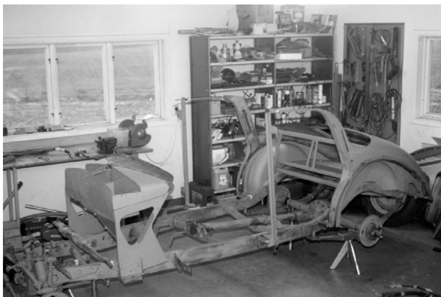
Paneler och fästen för A-stolpar samt bakre hjulhus inkl. bagagerumsdurk färdig-svetsade för min del. Plåtexperten får fixa bakskärmsanslutningar och C-stolpar.
