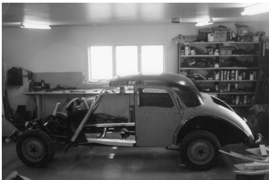
Hopbyggnad av karossen. Här möts A-stolpar och takprofiler.
