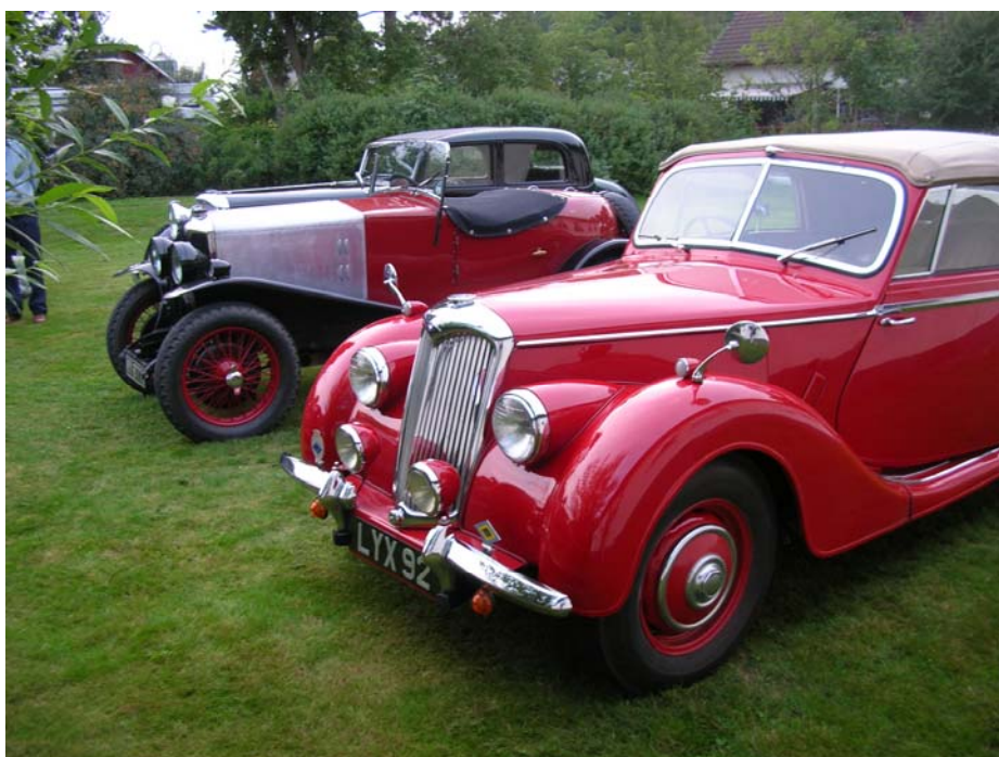
Jim Fletchers 1½ Litre Drophead Coupé var en av fyra prototyper som fabriken tog fram 1946. De serietillverkade cabrioleterna som kom först tre år senare skiljde sig på tre viktiga punkter: 2½ litersmotor, bredare överkant på vindrutan och den moderna instrumentbrädan.
