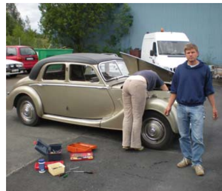
42 S 20002 - den med lösa högspänningsledningen. Sjöingenjören hade de minsta fingrarna och fick därför utföra (det onödiga) bensenpumpsbytet x 2.
