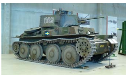
Stridsvagn M/41: motor 6 cyl 160 hk Scania, Wilson planetväxellåda och Bofors 37 mm kanon. 116 byggda. Vikt 10 ton. Besättning: 4.
