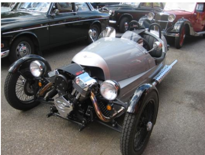
Hans Hedströms Morgan 3 Wheeler 2014 med amerikansk S&S V-Twin motor på 1976cc
