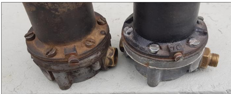
Till vänster äldre, till höger nyare SU-pump (större respektive mindre jordskruv).
