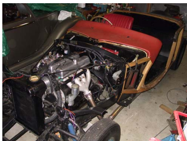
Ny kabelhärva från Autosparks i England har dragits. Per har under hösten testat bilen i befintligt skick längs bygatan i Domsten vilket väckte viss uppmärksamhet...
