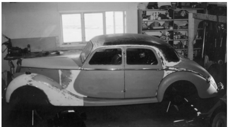
Spacklat och slipat. Vindruta, lister m.m. provmonterade.
