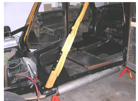
A-stolparna provisoriskt monterade
