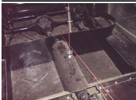
Snöre med lod från garagetak till centrumsnöre i bil
