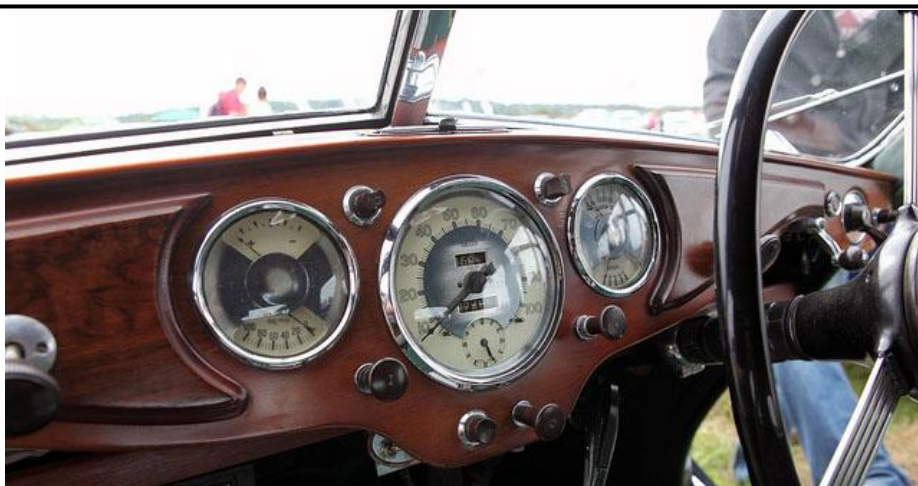
Bild 2. Den 2:a typen av instrumentbräda med runda instrument (1945-1949). Genomgående rakfibrig faner och med askkopp ovanför hastighetsmätaren. Bruna knappar och handbromskrycka.
