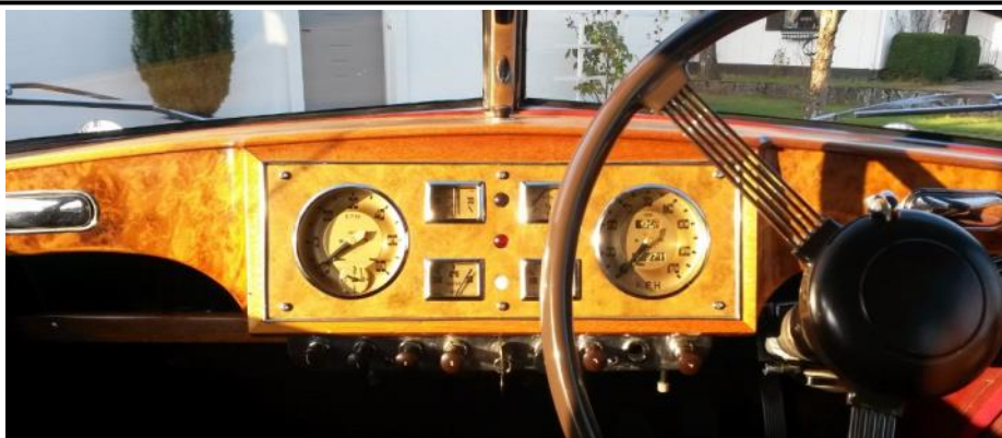
Bild 6. Den moderniserade RM instrumentbrädan (1949-1955). Reds bil. En ny ådermålad plåt (Woodman, Insjön, 2014). Den ursprungliga milesmätaren utbytt mot en kilometermätare ca 1990. Den ursprungliga pärlbeige ratten i acetat är utbytt mot en brun stålrott inköpt från RM klubben 1996. Stora klockan är utbytt mot en varvräknare med liten klocka 2013.
