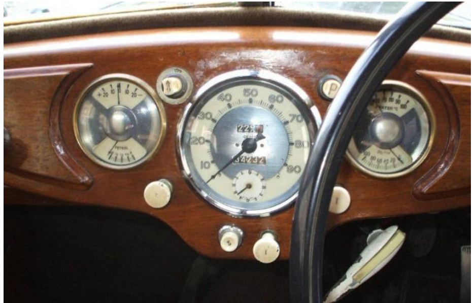
Bild 1. Den tidigaste RM instrumentbrädan (1945) med rundad överkant, vita knappar och handbromshandtag som det såg ut i de första 120 bilarna. Faner på "fiskfiléerna" men inte på instrumentbrädan.
