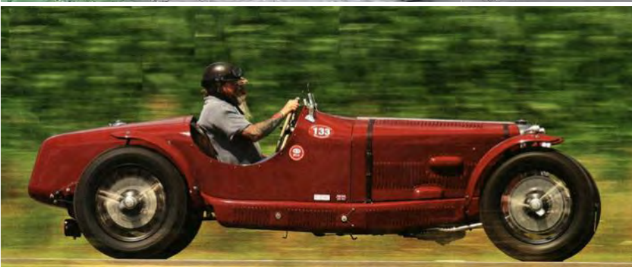
Die Karosserie des Specials hat kein Holz, sondern ein Alu-Gerüst. Schon im Werk entstanden die meisten sportlichen Aufbauten auf diese Weise
