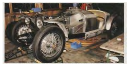
Die Karosserie des Specials hat kein Holz, sondern ein Alu-Gerüst. Schon im Werk entstanden die meisten sportlichen Aufbauten auf diese Weise
